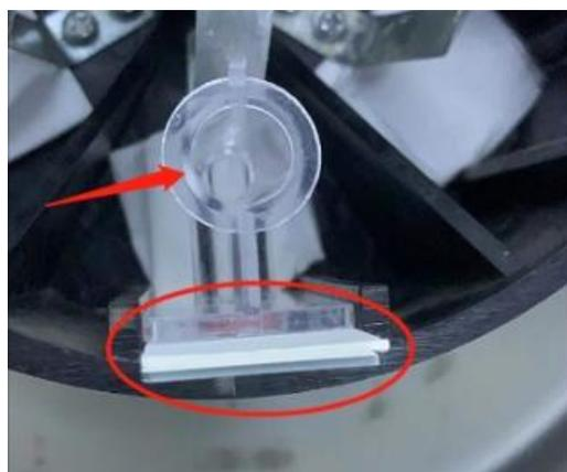
图 A.5 吊片在涂片机中放置示例图
